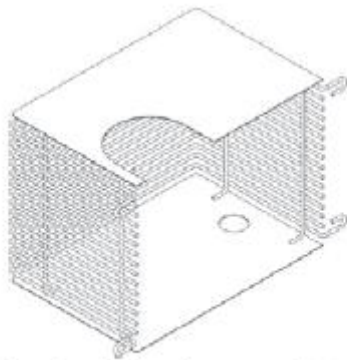
Защитная сетка вытяжного вентилятора, общая для обоих газовых обогревателей GH0625sa - GH0640sa.
